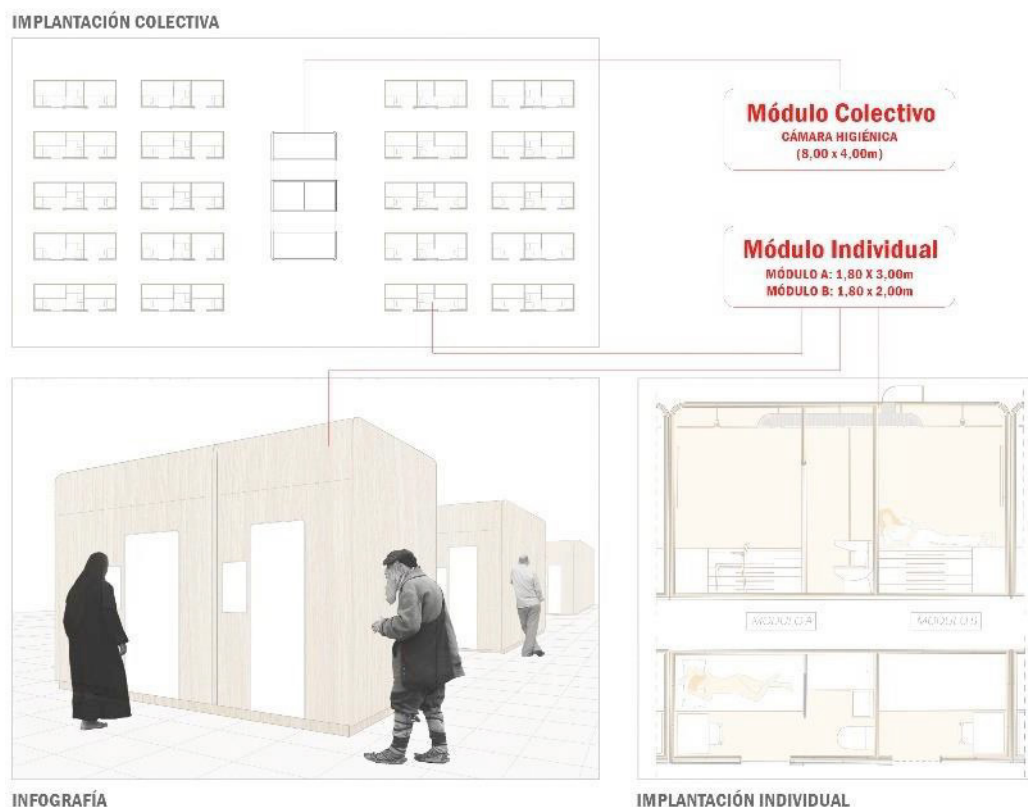
Figura 3. Diseño de vivienda temporal para usuarios. Módulos periféricos individuales (modelo A con baño integrado, B sin baño), con módulo central de almacenamiento y cámara higiénica. (Ortiz)
